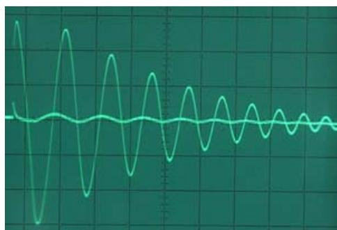
图 6. 断线波形
