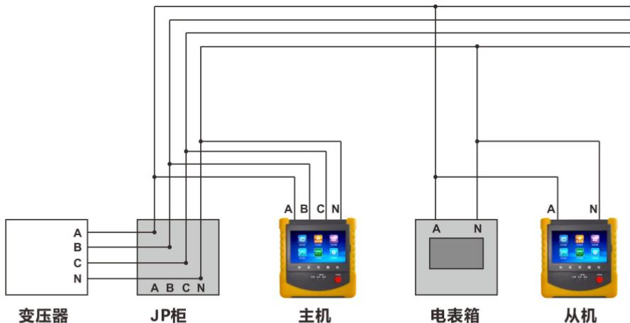
2) 220V 测试线: 先将红色插头接入从机的黄色端子, 再将黑色插头接入黑色端子, 确保无松动(注意: 从机必须从 A 相进行识别测试, 否则无法对设备供电)。
