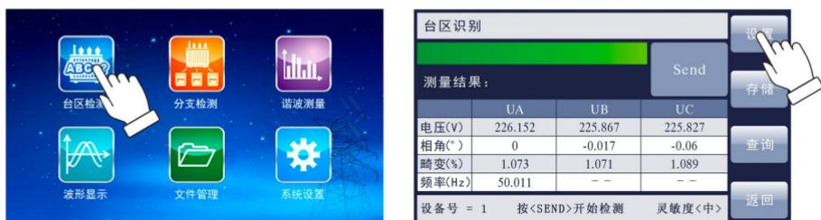
进入设置, 可以预先设置主机、从机的设备地址(即台区进行编号), 设置从机为“1”号设备, 主机设置为“2”号设备。
