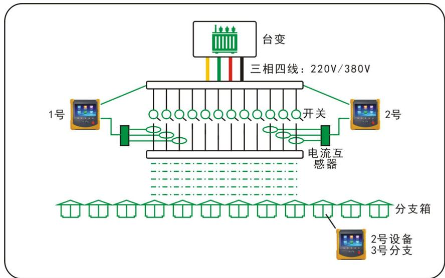
分支端的测试设备接好测试线，并设置好设备号的信息（分支端测试设备地址必须为唯一性否则检测不准确），再将一个或多个电流互感器依次夹在待测零线电缆上。在待测用户端设备按“SEND”键，在 6 秒内从机设备必会显示出对应的设备编号与分支信息（例如汉字显示“2 号设备 分支一”）。
