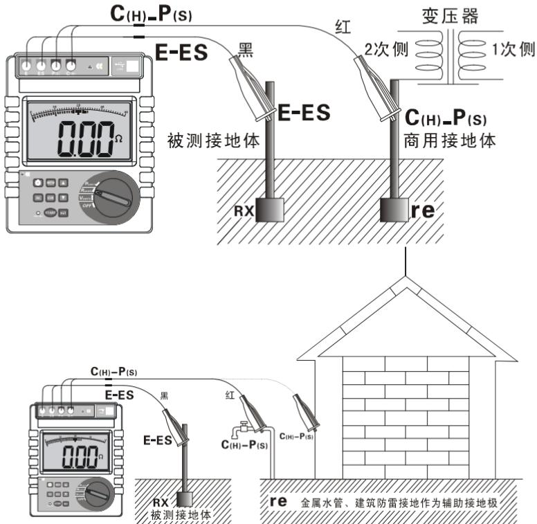
二线简易法测量接地电阻，其仪表读数为被测接地体的接地电阻值与商用接地体的接地电阻值之和，即：
