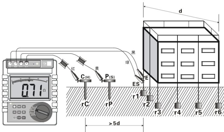
$$R = r_1 // r_2 // r_3 // r_4 // r_5 // r_6 // \dots // r_n \quad (r_1 \dots r_n \text{ 都是独立接地点})$$
