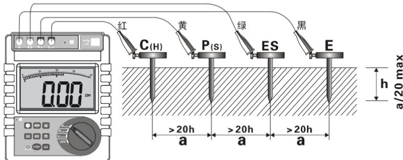
辅助接地棒的间距设置：连接好测试线后，先将转盘旋钮旋至“ $\rho$  EARTH”位置，进入土壤电阻率测试模式，长按“SET”键(约 3 秒)进入辅助接地棒的间距设置，短按“SET”键移动光标，按“ $\Delta$ ”或“ $\nabla$ ”键改变当前数字大小(a 值范围:1m~100m)，再长按“SET”键保存设定的 a 值，并返回土壤电阻率测试模式。
