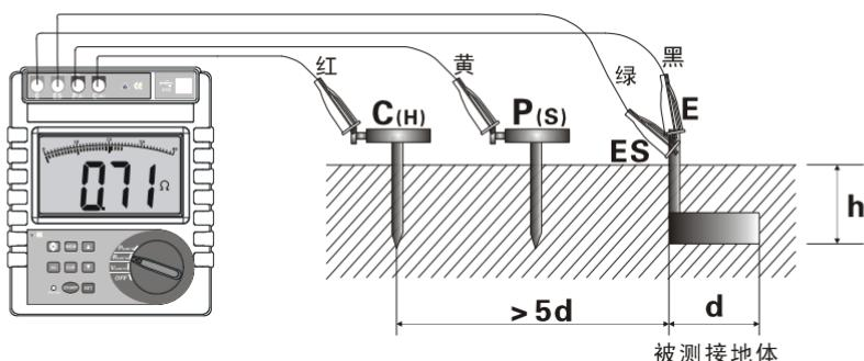
对于多点独立接地系统或大地网接地系统，用户自行选用更长的测试线即可，电极间距大于被测试地网最大对角线长的 5 倍即可。如下图：
