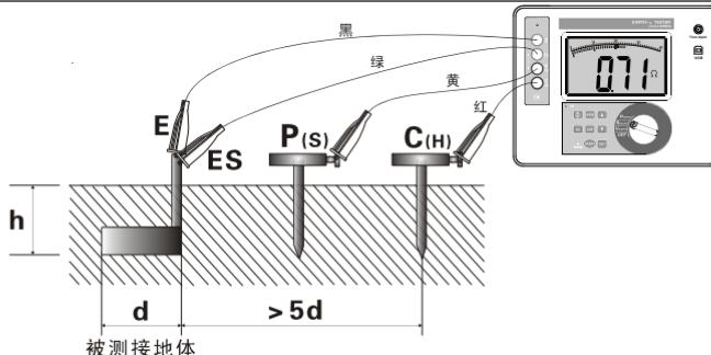
对于多点独立接地系统或大地网接地系统，用户自行选用更长的测试线即可，电极间距大于被测试地网最大对角线长的 5 倍即可。如下图：
