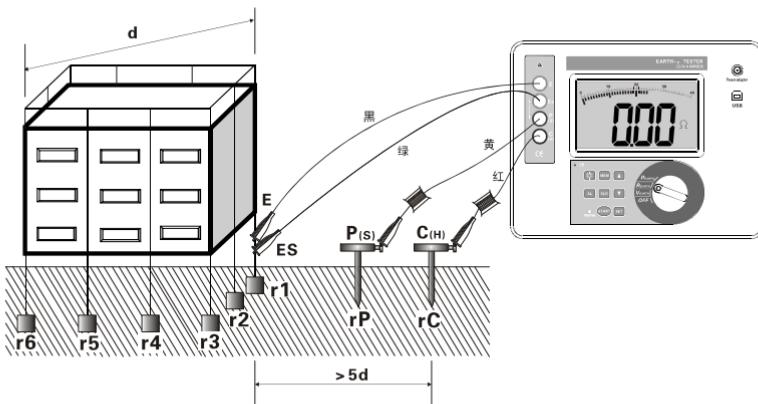
$$R = r_1 // r_2 // r_3 // r_4 // r_5 // r_6 // \dots // r_n \quad (r_1 \dots r_n \text{ 都是独立接地点})$$
