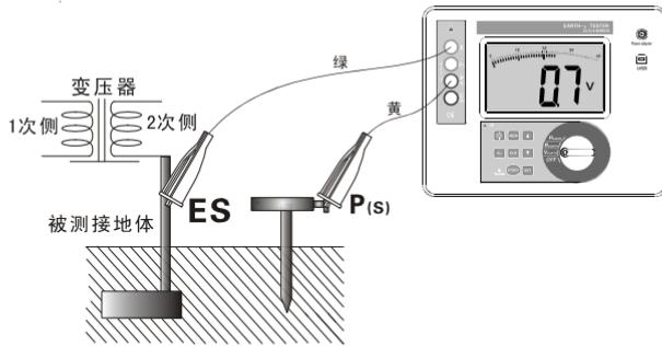
商用接地体对地电压测试
