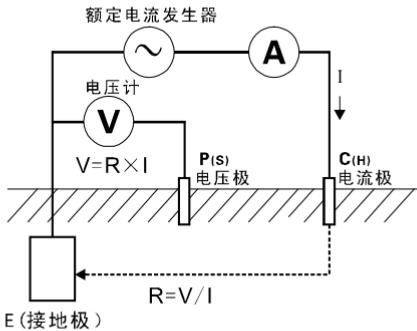
之间的接触电阻(通常有污垢或生锈)对测量的影响，能消除线阻对测量的影响，更精密。
