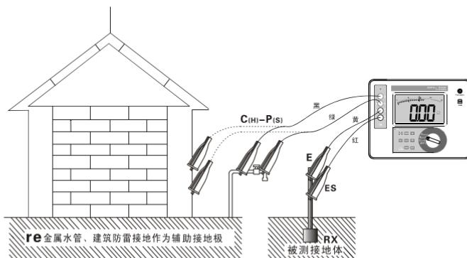
二线简易法测量接地电阻，其仪表读数为被测接地体的接地电阻值与商用接地体的接地电阻值之和，即：
