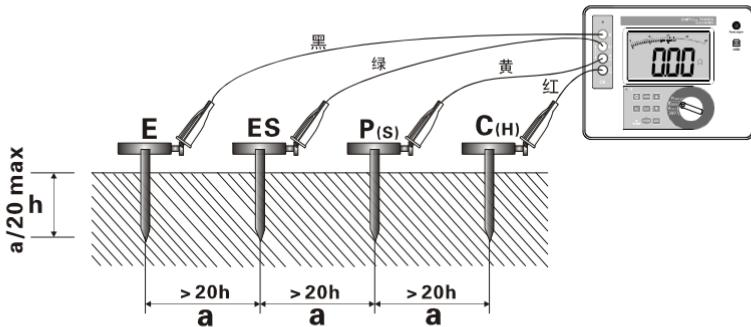
辅助接地棒的间距设置：连接好测试线后，先将转盘旋钮旋至“ **$\rho$  EARTH**”位置，进入土壤电阻率测试模式，长按“**SET**”键(约 3 秒)进入辅助接地棒的间距设置，短按“**SET**”键移动光标，按“**▲**”或“**▼**”键改变当前数字大小(**a** 值范围:1m~100m)，再长按“**SET**”键保存设定的 **a** 值，并返回土壤电阻率测试模式。
