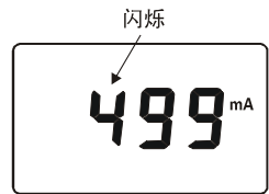
图14. 电流报警临界值设定
