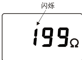
图13. 电阻报警临界值设定 图14. 电流报警临界值设定
