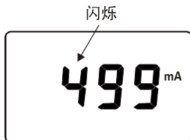
图13. 电阻报警临界值设定 图14. 电流报警临界值设定
