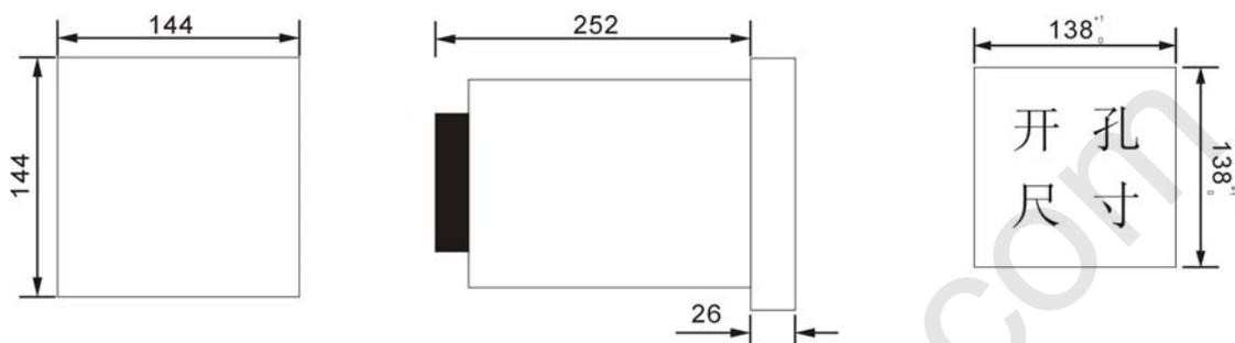
图6.1 仪表外形尺寸，安装方法及开孔尺寸
