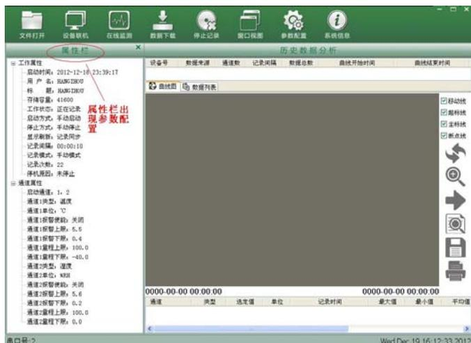
当记录仪硬件联机成功后，将出现上述窗体，否则软件会提示您“设备联机失败，请检查通信情况”的对话框。未正常连接记录仪，您将无法操作该软件。
