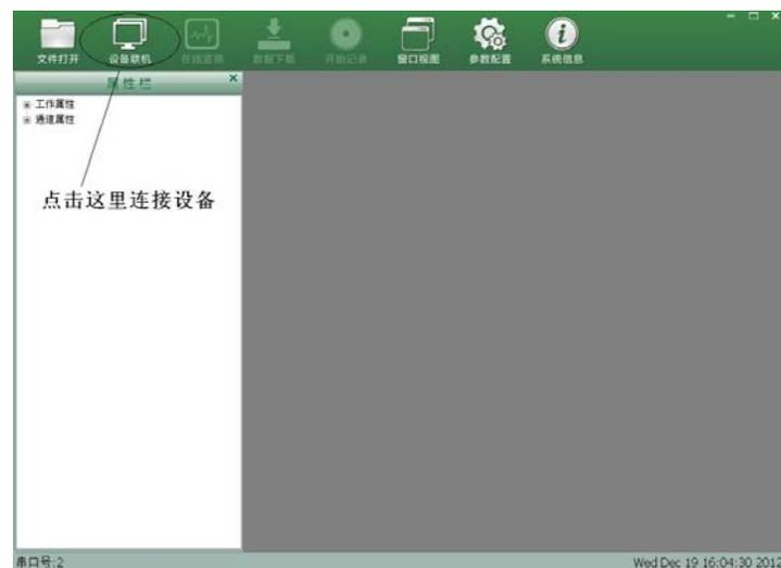
连接后的界面，会在属性栏中出现记录仪相关的参数设置(例如启动方式，记录间隔，及报警设置)。
