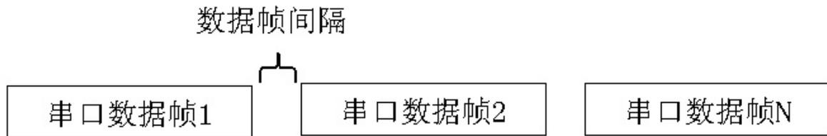
当在指定帧间隔时间内，没有接收到新的串口数据，就认为收到了一个完整的数据帧，此数据帧将被一次性转发到 TCP/IP 连接。串口服务器最大可以缓冲 512 字节的数据帧。
