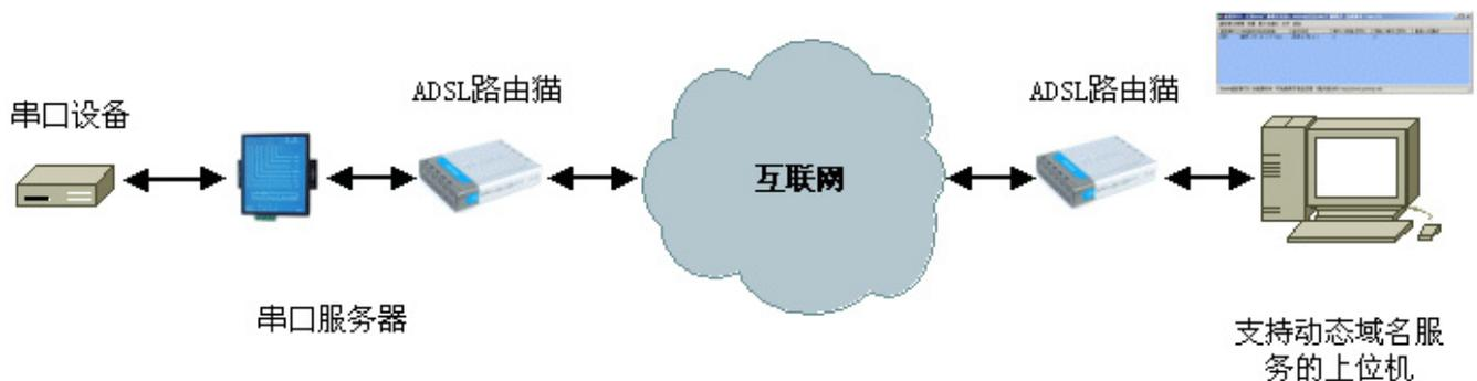
串口服务器的网关（如 ADSL 等）为外网动态 IP，远程主机也是外网动态 IP。这种情况下，必须申请“动态域名服务”来取得一个固定域名，用于串口服务器解析远程主机 IP 地址。
