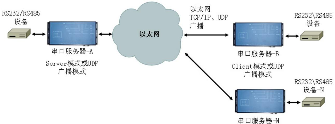
串口服务器 A 设置为 TCP/IP Server 模式，串口服务器 B 设置为 TCP/IP Client，并将 B 的远程服务器地址设置为 A 的 IP 地址，这 2 个串口服务器就可以实现透明传输。在 UDP 广播模式下，多个串口服务器的接收端口设置为 A 的发送端口，A 的接收端口设置为多个串口服务器的发送端口，这样就可以实现串口服务器的单对多透明传输。
