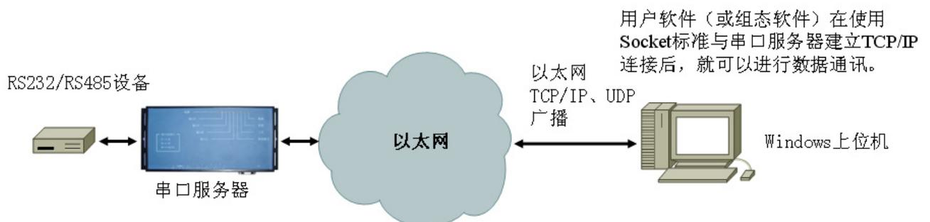
串口服务器采用原始数据（RAW Data）传输模式，在与串口服务器建立 TCP/IP 连接后，就可以直接传输数据。
