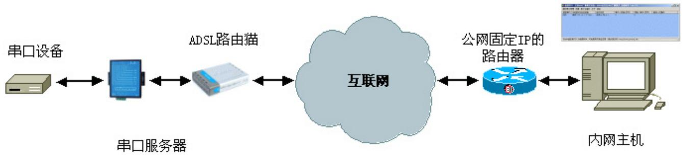
串口服务器可以通过互联网、网关连接到有固定 IP 内网主机，当主机在内网时，需要在网关上做 NAT 映射。
