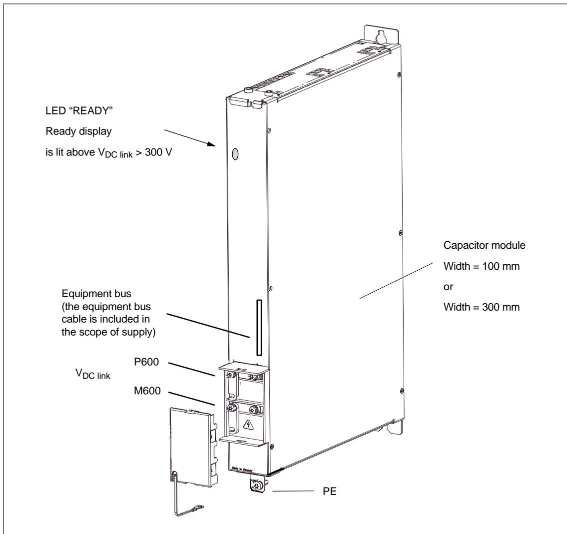
Fig. 6-11 Capacitor modules
