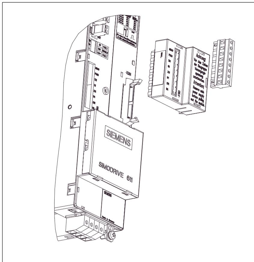
Fig. 2-8 Overvoltage limiting module
