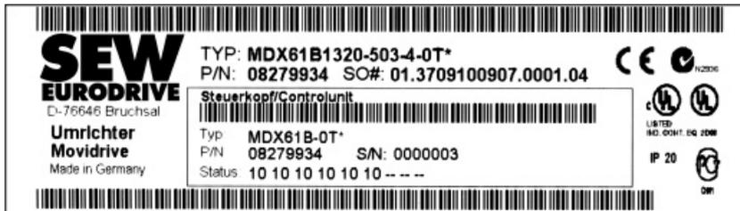
图 3: MDX61B.. 规格 1 ~ 6 系统铭牌示例
