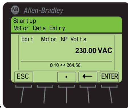
图 1-21 输入电机名牌电压
