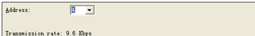
图 2- 12 设置 PROFIBUS 上的变频器地址
