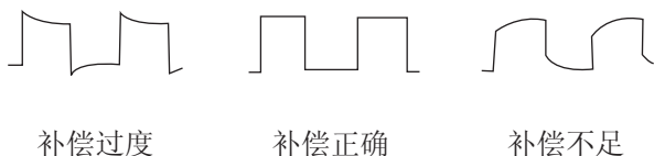
图1-8 探头补偿校正
