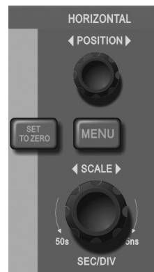
图1-10 面板上的水平控制区
