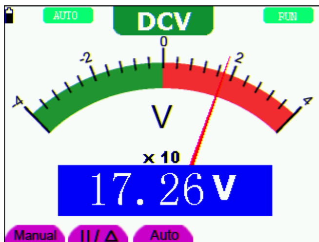
图 25: 直流电压测量界面
