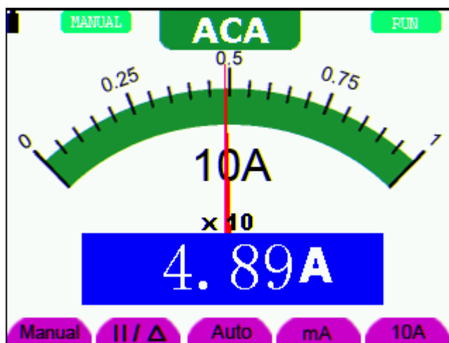
图 30：交流电流10A测量界面
