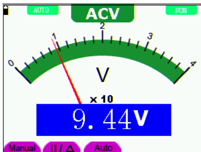
图 26: 交流电压测量界面
