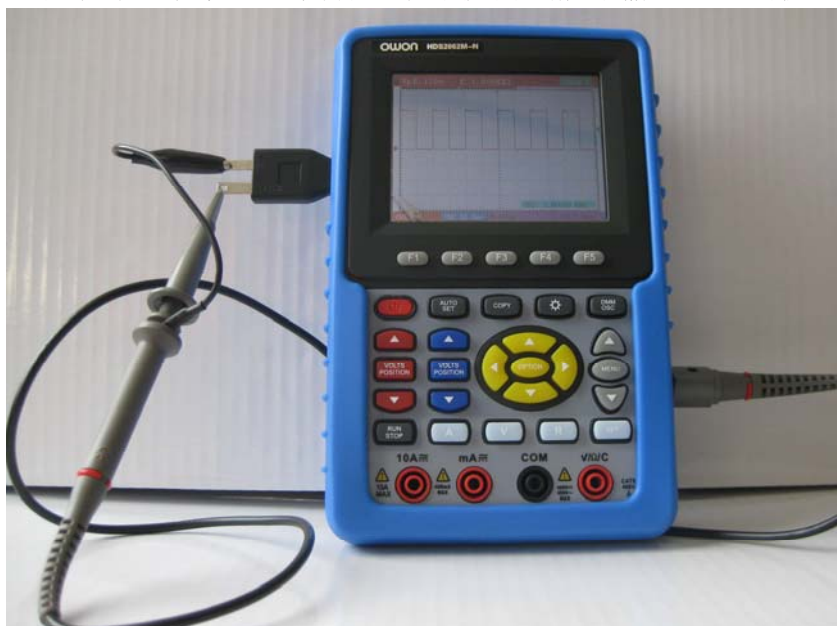
图 3 方波测试信号连接
