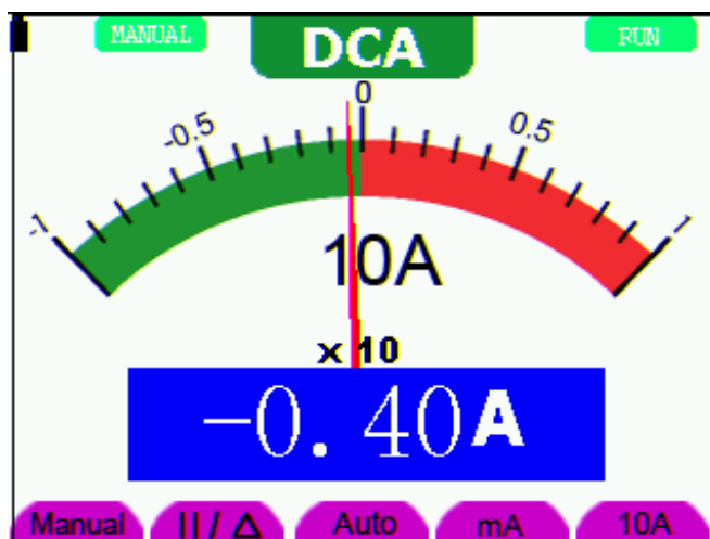
图 28: 直流电流10A量程测量界面
