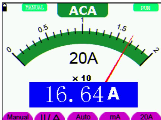
图 27: 交流电流20A测量界面
