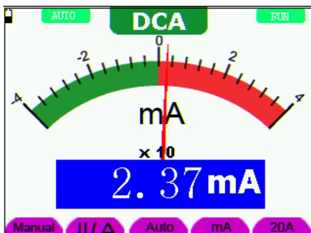
图 24: 直流电流测量界面
