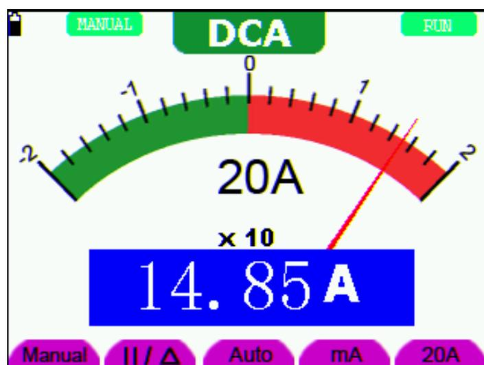
图 25: 直流电流20A量程测量界面
