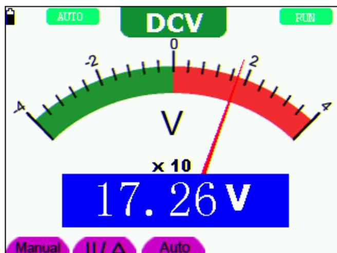
图 22: 直流电压测量界面
