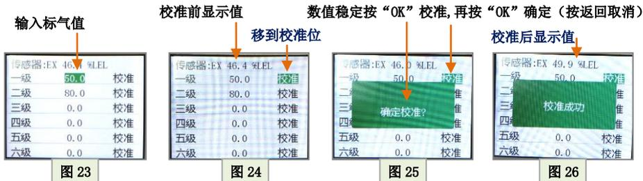
**操作步骤:**按照上图 20 所示连接好气路, 然后通过“上、下、OK”键依次进入传感器的校准界面 (上图 21、22), 在相应的目标点上输入标气值 (上图 23), 将光标移到“校准”位 (上图 24), 然后缓慢的开启标准气体并将流量控制在 500ml/min, 待显示稳定 (约 2 分钟) 后观察仪器的实时浓度值, 按“OK”键, 出现上图 25 “确定校准”提示, 最后再按“OK”键进行校准 (按“返回”退出校准)。校准成功显示上图 26; 校准失败则会显下图 27/28
