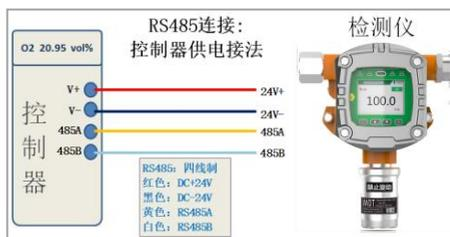
**通讯线的选择：屏蔽双绞线或屏蔽电缆线，布线方式选择总线制或手拉手接法!!!**
