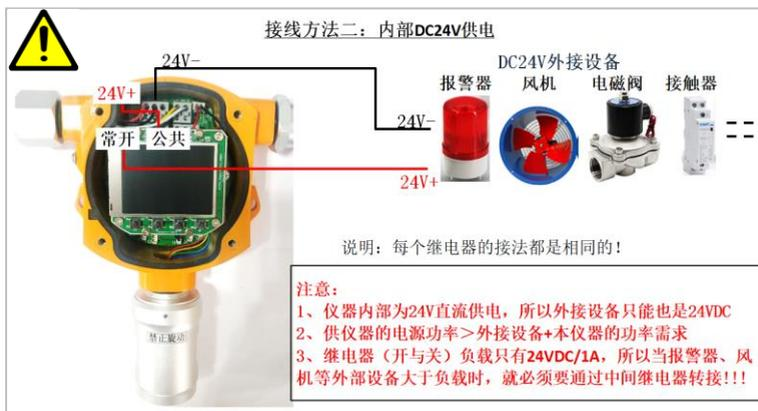
说明：报警点与继电器的对应关系：报警点 1~继电器 1；报警点 2~继电器 2；报警点 3~继电器 3（选配）
