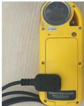
将数据线连接上连接器的RS232接口
