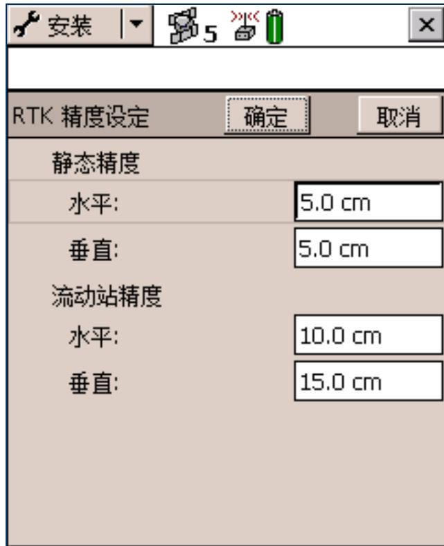
RTK 精度设定窗体截图。窗体顶部显示“安装”按钮和系统图标。窗体标题为“RTK 精度设定”，右侧有“确定”和“取消”按钮。窗体内容分为“静态精度”和“流动站精度”两部分。静态精度部分包含“水平”和“垂直”两个输入框，均设置为 5.0 cm。流动站精度部分包含“水平”和“垂直”两个输入框，分别设置为 10.0 cm 和 15.0 cm。
