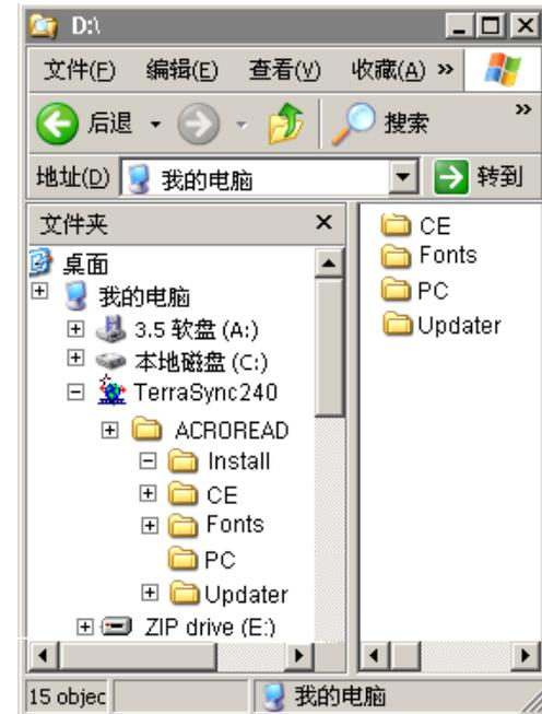
**提示** — 如果要在外业现场使用《TerraSync 操作指南》、《TerraSync 发行说明》或“**TerraSync Updater 实用程序**”，请将整张光盘的内容复制到目标 PC 机上。不必复制 Install\CE 或 Install\Fonts，这些文件夹中的文件只用于 Windows CE 安装。
