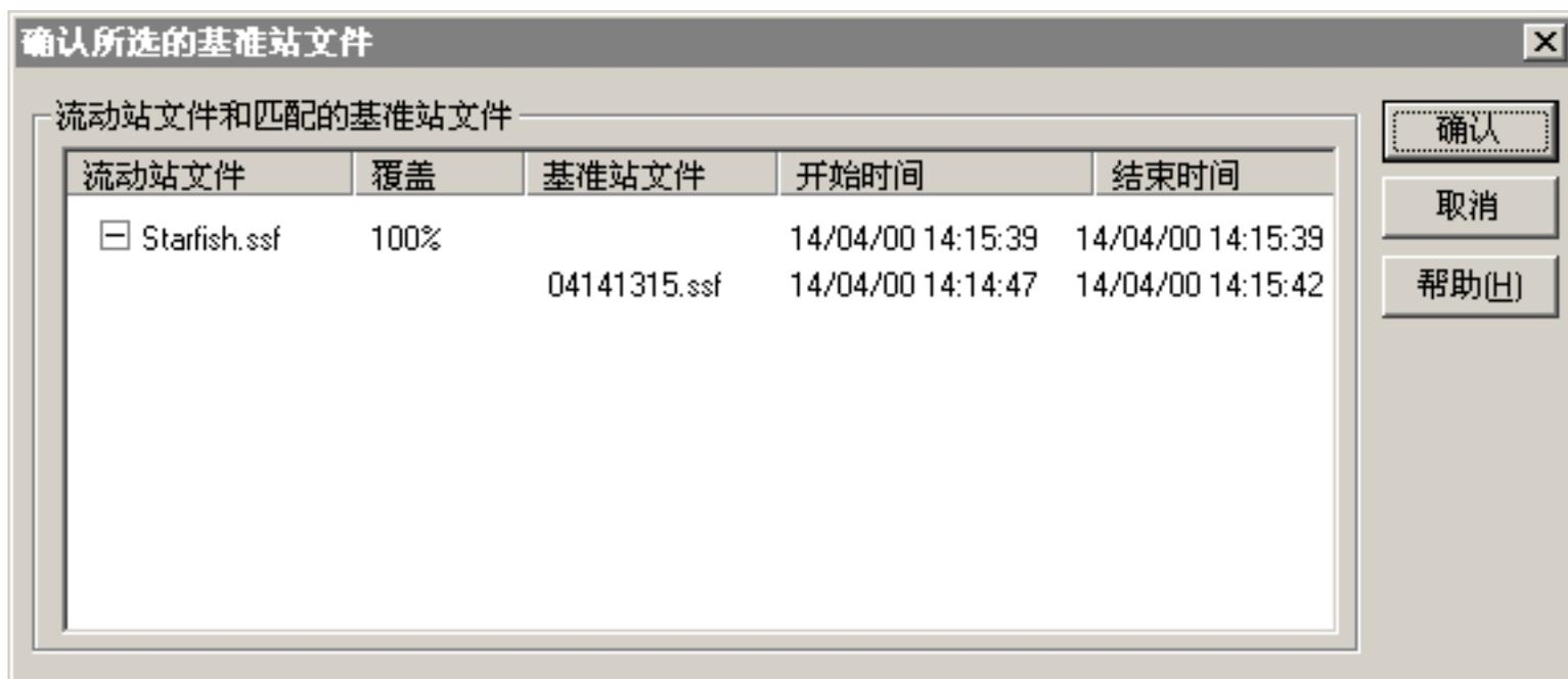
5. 使用“确认所选的基准站文件”对话框可确保所选基准站文件与流动站文件存在共同时间。单击“确认”。“参考位置”对话框随即出现。
