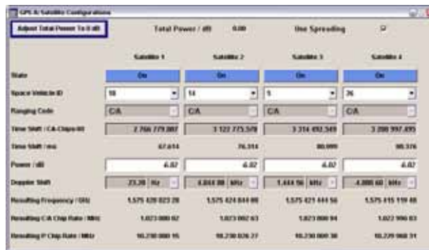
通过R&S®AMU200A的各个通用编码模拟四个GPS卫星
