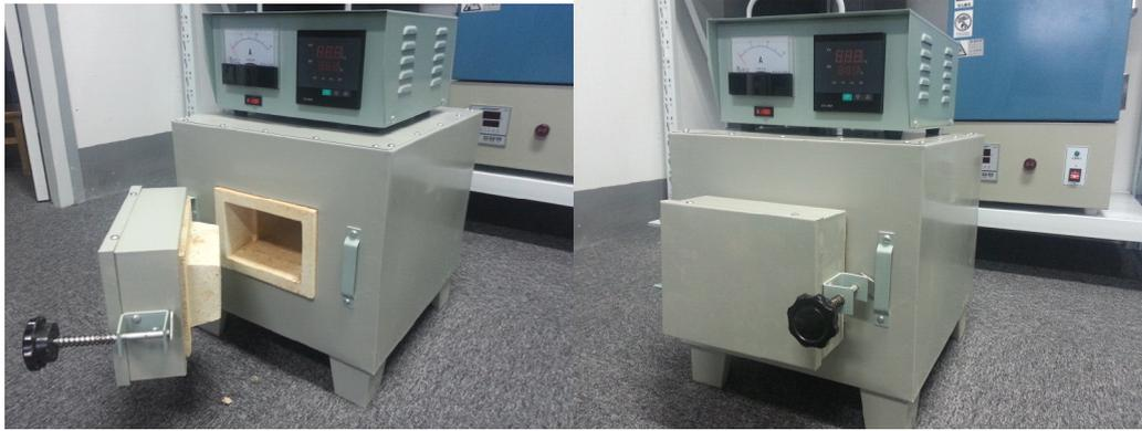
本系列电阻炉可供实验室、工矿企业、科研单位作元素分析测定，小型钢件淬火、退火、回火时加热用。
