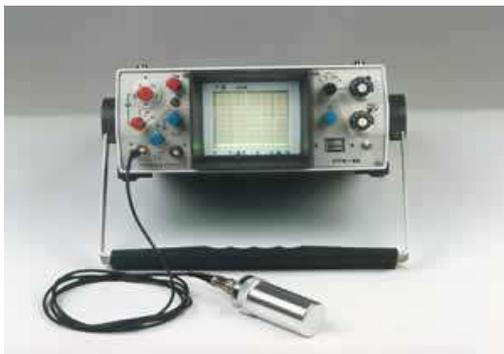
CTS-22A 型超声探伤仪是携带式 A 型脉冲反射式超声波探伤仪，可用交流电或电池供电工作。仪器采用高亮度、内刻度矩形示波管，具有工作频率宽、探伤灵敏度高、稳定性好、波形清晰和体积小、重量轻、耗电省以及操作方便等特点。
