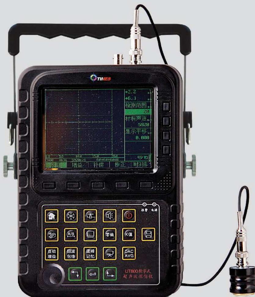
UT800是一款便携式、数字式超声波探伤仪。它能够快速便捷、无损伤、精确地进行工件内部多种缺陷（裂纹、夹杂、气孔等）的检测、定位、评估和诊断。既可以用于实验室，也可以用于工程现场。本仪器能够广泛地应用在制造业、钢铁冶金业、金属加工业、化工业等需要缺陷检测和质量控制的领域，也广泛应用于航空航天、铁路交通、锅炉压力容器等领域的在役安全检查与寿命评估。
