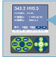
从薄膜键盘输入压痕对角线的长度，内置计算器自动计算出硬度值并显示在LCD屏上
