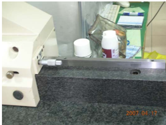
圖 2-3 三次元量測儀之 Y 軸滑軌(拆卸前)
