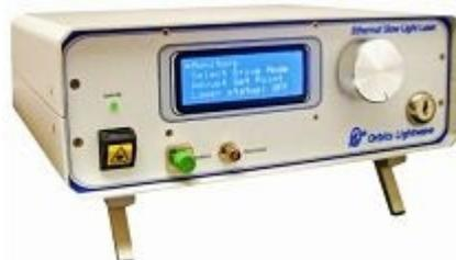
简介：1064、1550nm超窄线宽光纤激光器，可选PZT调节，输出功率可达175mW，线宽< 400Hz (200可选)
