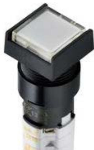
LUMOTAST 75 IP40, 发光按键, 正方形卡圈, 平灯罩. 触感的. 1开 + 1关
