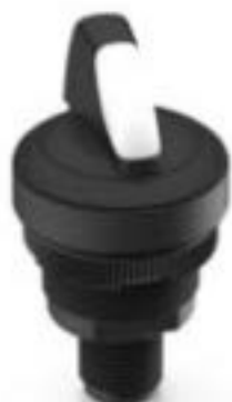
RAMO 22 S, M12, 圆形卡圈, 2 关, 金触, M12 8-极 A-编码, 前圈 黑色, 1 x 90°, 1 x 40°, 触感的/声感的
