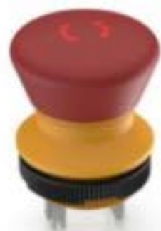
LUMOTAST 22, 急停按钮, 2 开 + 1 关, 银触, 快插端子 2.8 x .8, 镀锡, 复 位 通过旋转, 箭头 红色
