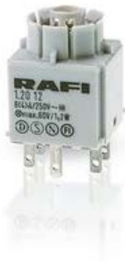
RAFIX 16, 标准触点模块, 银触, 无灯座, 快插端子, 2 开
