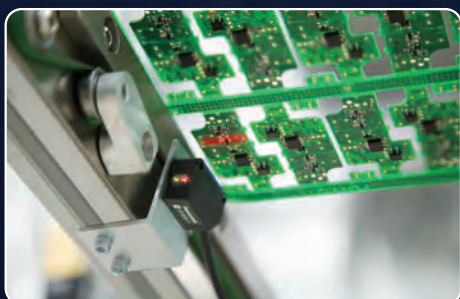
不被基板的切口、镂空所影响， 能稳定的检查基板位置
