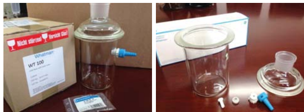
WT100集液/缓冲瓶，可卸瓶盖，方便倾倒溶液，带SB真空连接管
