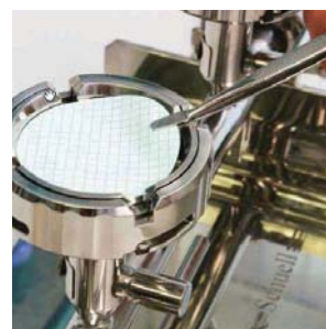
图4 过滤完毕，拾取滤膜、培养和观察。
