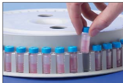
Mini-Uniprep 置于HPLC 启动取样器中
