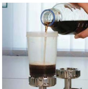
图3 将液体样本倒入漏斗并启动隔膜真空泵。
