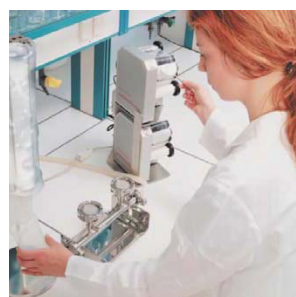
图1 取一支灭菌的漏斗，用取膜器分配一张滤膜。
