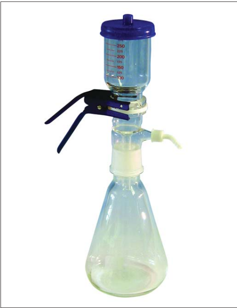
GV050/2 玻璃真空抽滤装置 (含 NS45 1000ml锥形瓶)
