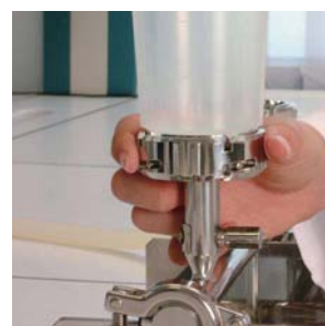
图2 将100ml或350ml的漏斗安装于AS220过滤装置上
