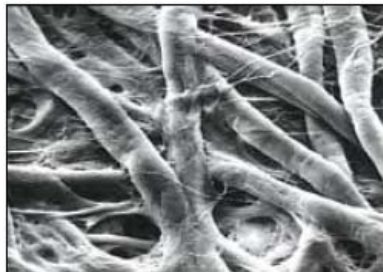
Whatman纤维滤纸能截留小至2.5 μm的颗粒物质。
