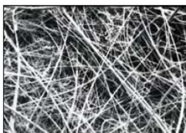
玻璃纤维滤器采用100%硅酸盐玻璃生产。
