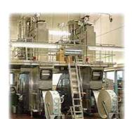
牛奶在彻底灭菌后就可以进行包装了,包装用过氧化物溶液消毒,用 *QUANTOFIX®* Peroxide 25 (Cat. No. 913 19)测试条对成品中的过氧化物残留物进行检测。
