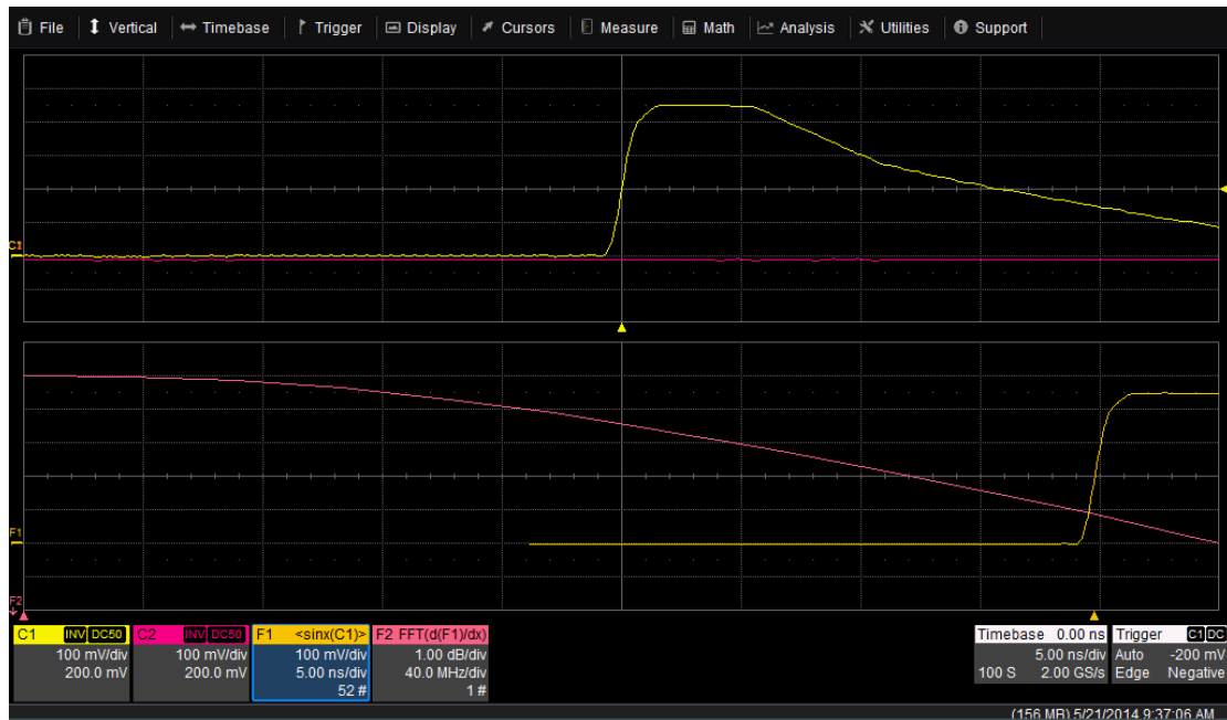
图 8 鼎阳 SDS3050 的快沿 FFT 运算
