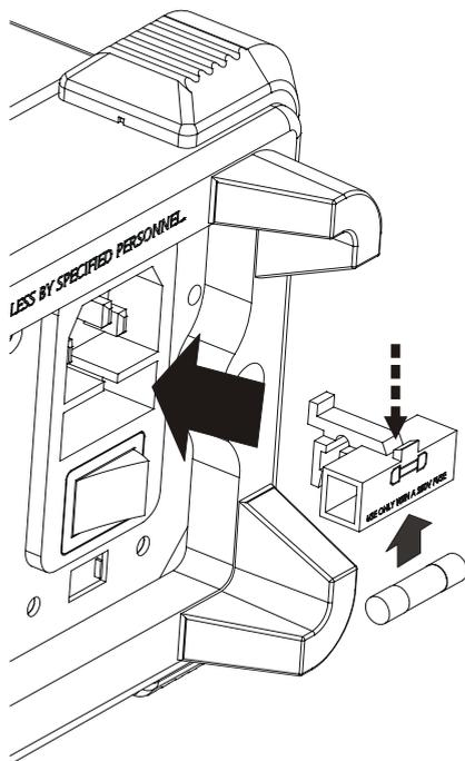
图 4-1 更换电力保险丝示意图
