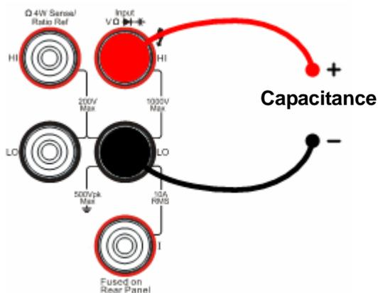
图 1- 25 电容测量示意图
