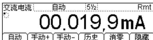
图 1-15 交流电流测量数据显示界面
