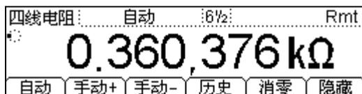
图 1-21 四线电阻测量数据显示界面
