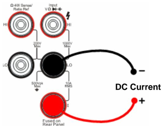
图 1- 13 直流电流的测量示意图
