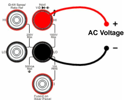
图 1- 10 交流电压的测量示意图
