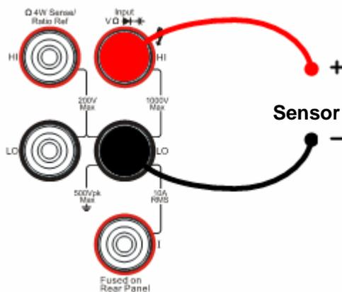
图 1- 49 电压、电阻、频率型传感器连接
