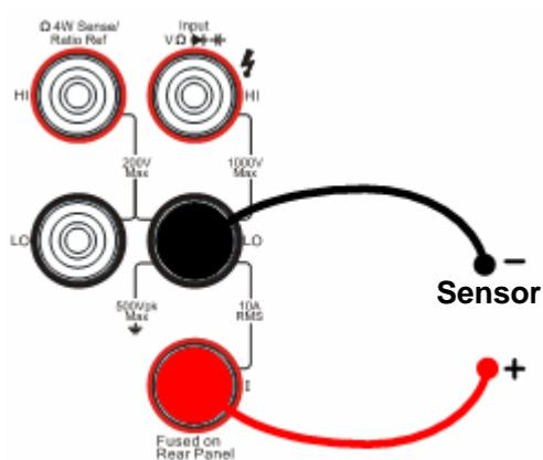
图 1- 50 电流型传感器连接
