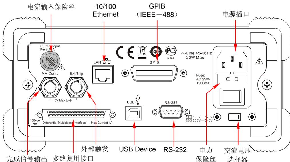
图 1-4 DM3000 后面板操作说明图
