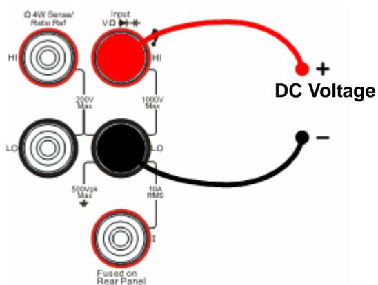
图 3- 7 直流电压的测量示意图
