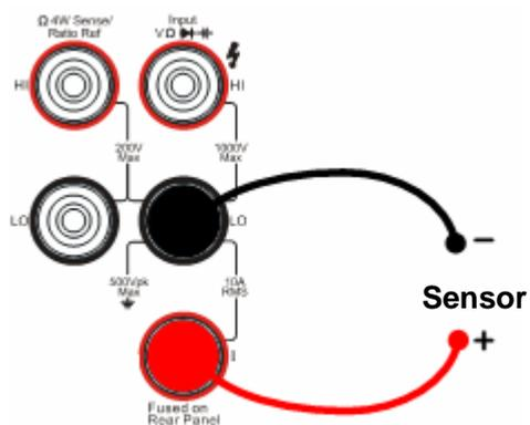
图 3- 19 电流型传感器连接
