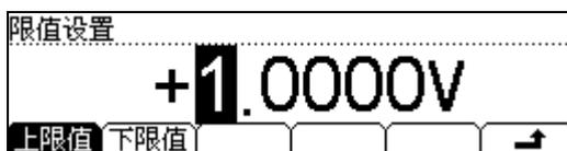
图 3-5 启用极限测试设置界面
