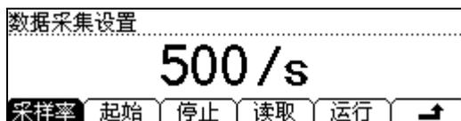
图 2- 57 DataLog 采样率设置界面
