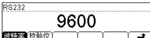
图 2- 41 RS-232 串行接口设置
