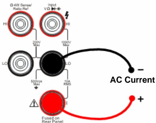
图 2- 9 电流信号频率测量连接示意图
