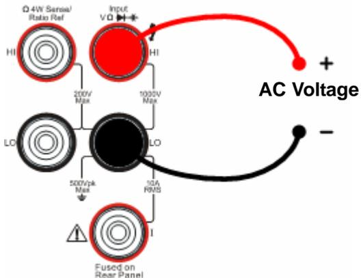
图 2- 8 电压信号频率测量连接示意图
