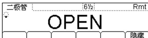
图 1- 29 检查二极管的数据显示界面
