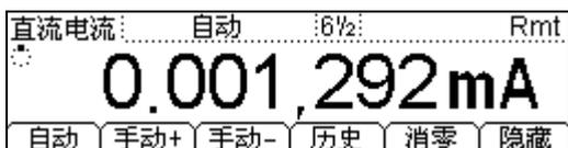
图 1- 12 直流电流测量数据显示界面
