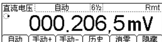
图 1-6 测量直流电压数据显示界面
