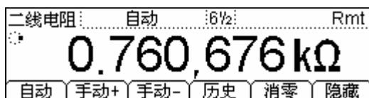
图 1- 18 二线电阻测量数据显示界面
