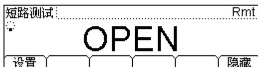
图 1-27 连通性测试的数据显示界面
