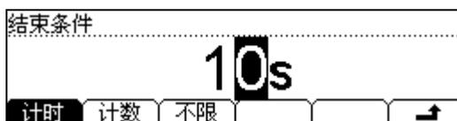
图 2- 60 DataLog 停止方式设置界面
