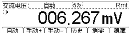
图 1-9 交流电压测量数据显示界面
