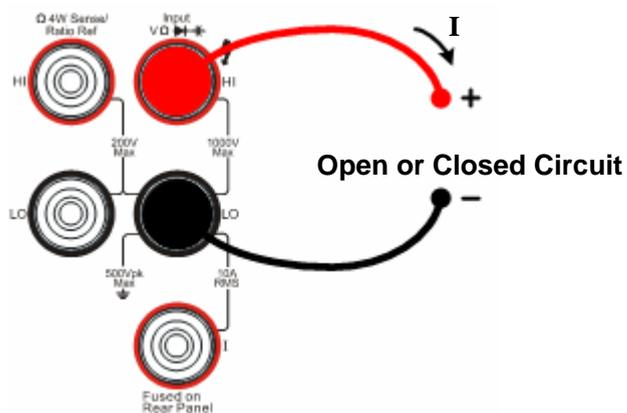
图 1- 28 连通性测试示意图
