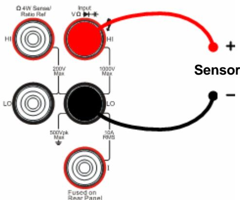
图 3-18 电压、电阻、频率型传感器连接
