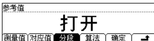
图 1-45 新建任意传感器算法分段打开/关闭选择界面
