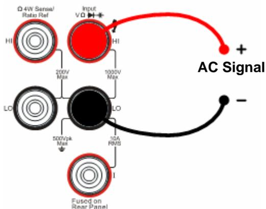
图 1- 32 频率测量的示意图
