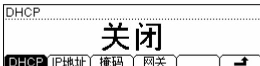
图 2- 38 IP 设置界面（DHCP 关闭）
