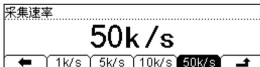
图 2- 61 Datalog 采集速率设置界面
