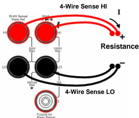
图 1- 22 四线连接法测量电阻示意图
