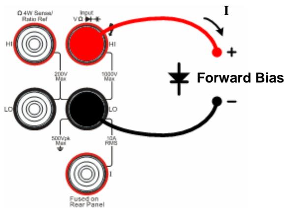
图 1- 30 二极管检测示意图
