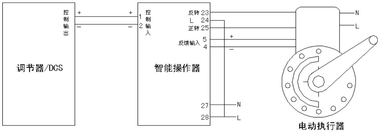
例 2 智能操作器与 DCS 控制系统、电动执行器组成的控制回路：
