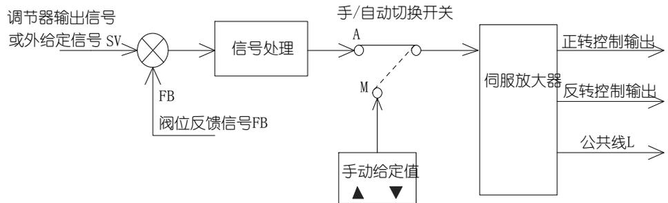
D型手操器控制原理图
