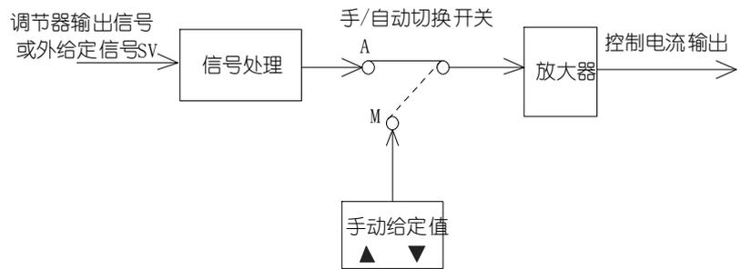
Q型手操器控制原理图
