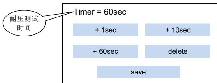
设置方式和上面一样。例如以默认设置 60 秒为例：以固定的 1000V 电压进行测试，最长测试时间为 60 秒，当发生击穿时，测试停止。如果超过 60 秒仍未击穿，可设置更长的时间进行测试。
