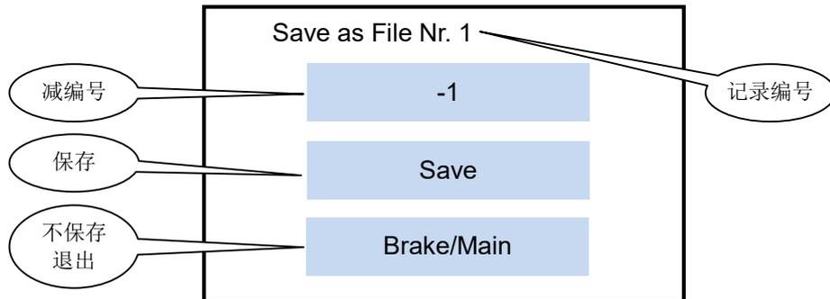
屏幕第一行显示该测试的记录编号（自动按顺序生成），点击“Save”以该编号保存这次测试数据。点击“-1”覆盖已存在的最后一个测试记录，例如已有 5 个测试记录，点击“-1”后，该次测试数据覆盖已存在的第 5 个测试记录。
