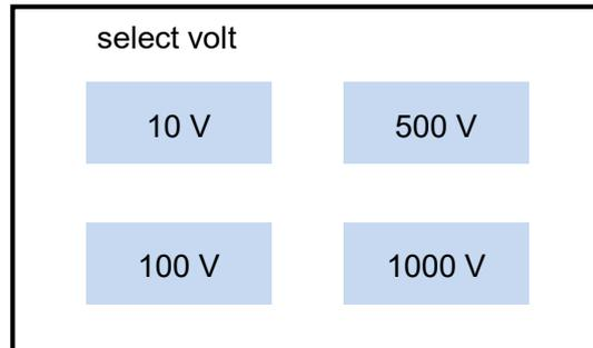
点击选择某个测试电压后，屏幕自动返回主界面。注意：如果已经选择了“Umess/Auto”自动测试电压，在该项无法再选择测试电压。如果先在该项设置了测试电压，无论设置那个测试电压，选择“Umess/Auto”以后，仪器只采用 10V 或 100V 自动测试。
