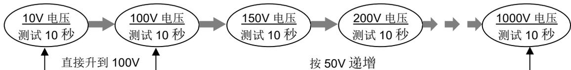
◇ Break Off T: 设置耐压测试时间，点击该项，屏幕显示如下：
