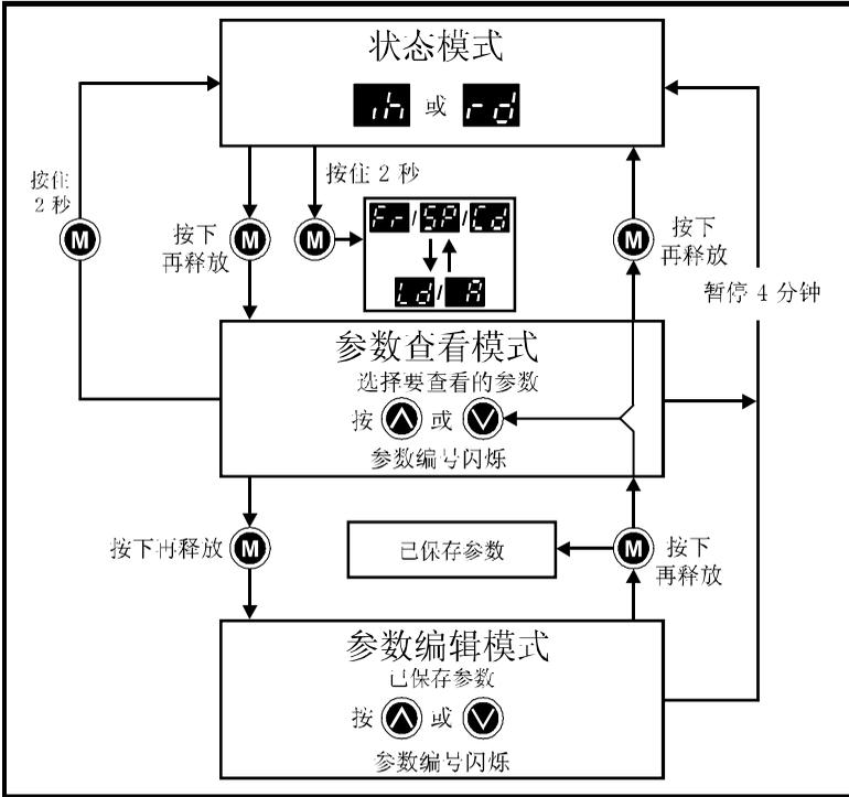
状态模式中按住 **M** 模式键 2 秒钟，显示屏所显示内容将会在速度与负载率显示之间切换。
