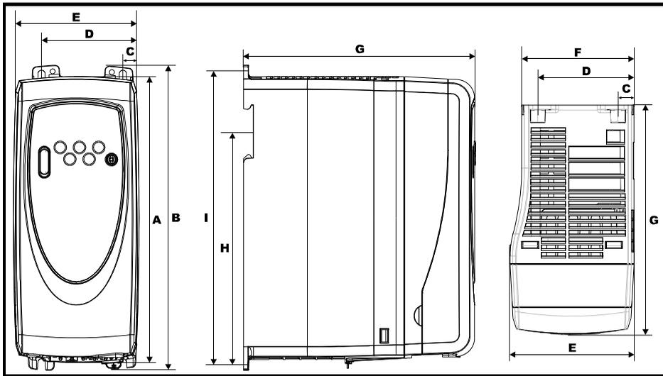
安装孔：4×M4 孔（A 至 C 型尺寸），4×M5 孔（D 型尺寸）
