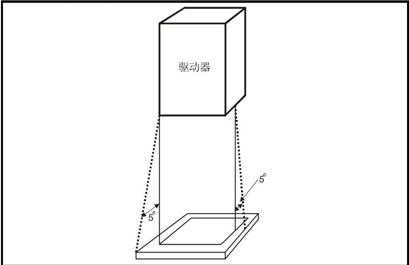
底部与被视为底部一部分的侧面必须避免接触易燃材料，设计时可不设开口或加入挡板结构。即，电缆等部件的出入口必须用满足 5VB 要求的材料密封，或在其上方安装挡板。合格的挡板结构见图 3-2。本结构不适用于混凝土地板的封闭电气操作区（限制访问）。
