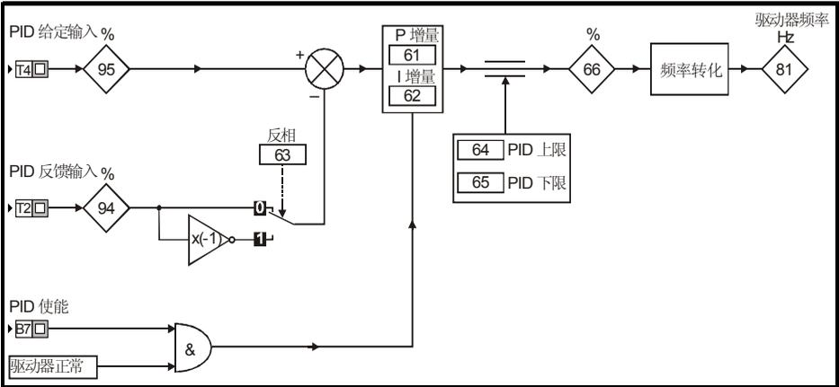
图 6-10 参数 参数 05 = HVAC 端子配置
