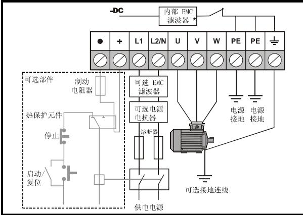
图 4-2 B、C、D 型驱动器的电源端子连线
