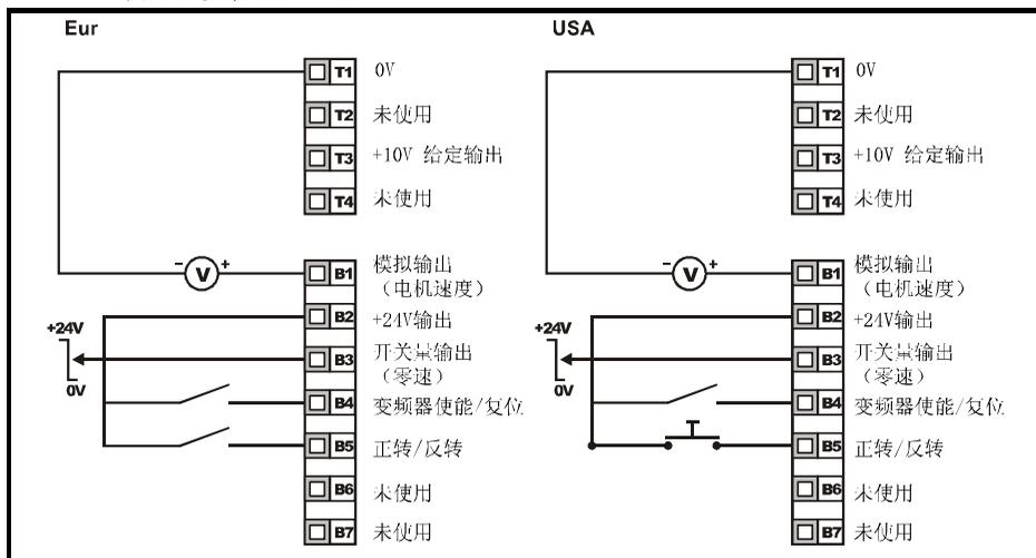
**在键盘控制模式下设置正转 / 反转端子**
