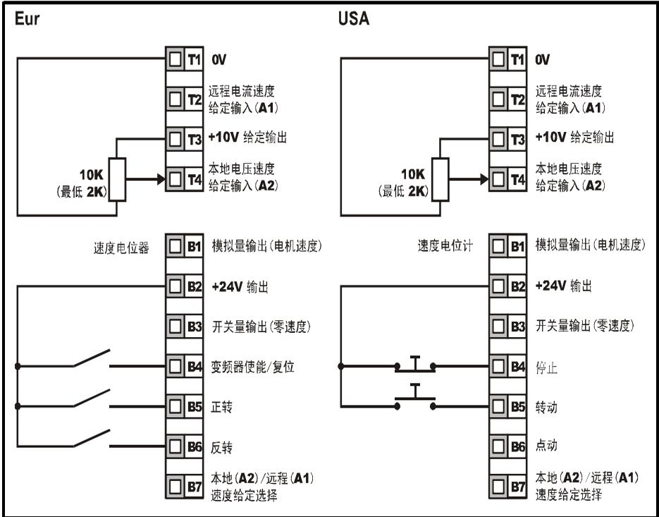
端子B7断开：选中本地电压速度给定 (A2)
